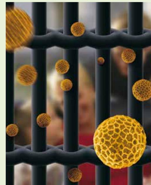
Durch das weitmaschige Gewebe gelangen sehr viel Luft und Licht in die Räume. Die Pollen bleiben dagegen am Gewebe hängen. Sie werden von einer Spezialbeschichtung des Polyestergewebes angezogen und festgehalten. Das Gewebe ist mit Wasser leicht zu reinigen und verfügt über das ECARF-Qualitätssiegel für geprüfte Schutzwirkung:
